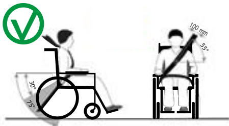
(C) Corretto montaggio delle cinture di sicurezza
