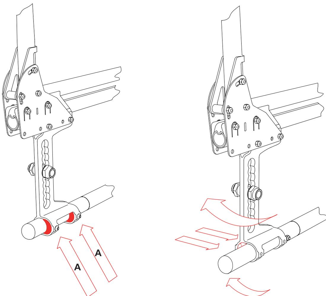
Die Verbindungsplatten zum Rückenrohr sind entsprechend dem Sturzwinkel gebogen und müssen nun in der korrekten Position montiert werden. Siehe Schritt II
