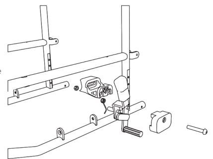
Bitte überprüfen Sie, dass die Feststellbremsen korrekt eingestellt sind.
