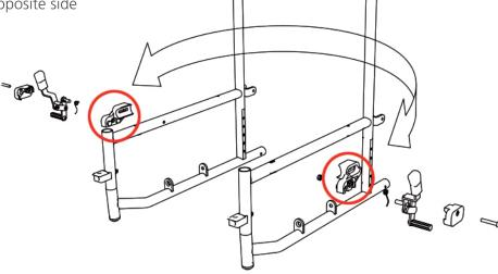
3 Die Montagehalterung ist nun nach hinten ausgerichtet. Montieren Sie die Feststellbremse anschließend und montieren diese am Rollstuhl.
