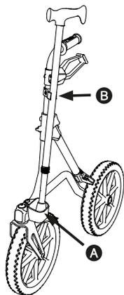
Si pour des raisons pratiques, vous préférez installer votre porte-canne à gauche, il est possible d'enlever la partie supérieure et la partie inférieure du porte-canne et de les attacher sur le côté gauche. Contactez un revendeur spécialisé agréé pour ce montage.
