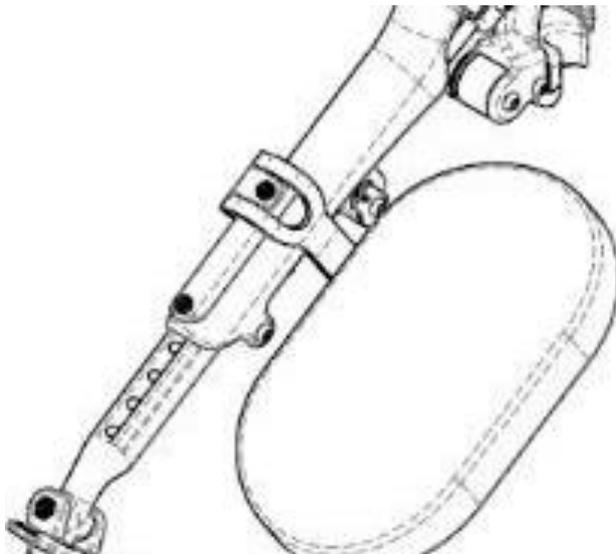
Abb. 4 Wegschwenkbare höhenverstellbare Beinstütze.
