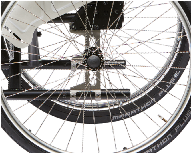
Einfache Radstands- und Sitzhöhenverstellung für den optimalen Fahrkomfort
