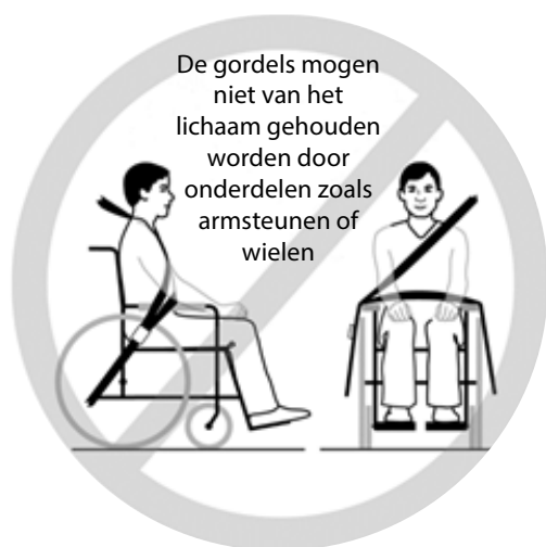
Figuur 3a - Onjuiste plaatsing van bek-kengordelsteunen over rolstoelsteunen.
