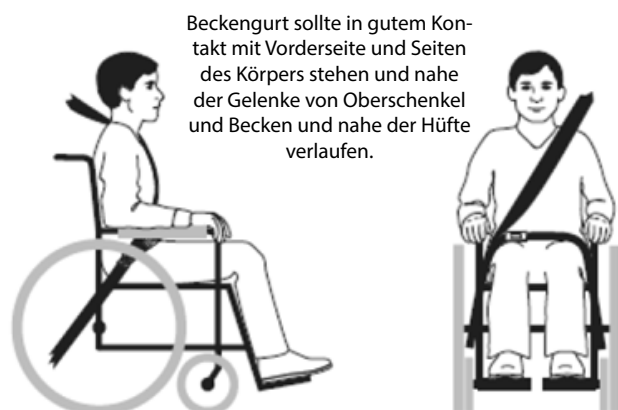
Abb. 3b – Ordnungsgemäßer Verlauf und Positionierung des Sicherheitsgurt am Rollstuhlnutzer.
