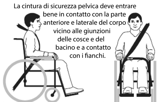
Figura 3b – Collocazione e posizionamento adeguati delle cinture di sicurezza sull'occupante della sedia a rotelle.
