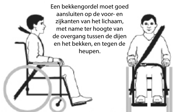
Figuur 3b - Juiste plaatsing van gordelbevestigingen op de rolstoelgebruiker.
