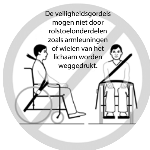
Figuur 3a - Verkeerde plaatsing van heupgordel over rolstoelsteunen.
